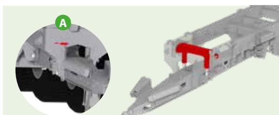
**Гидропневматическая подвеска** на моделях tridem (в опции на tandem).
