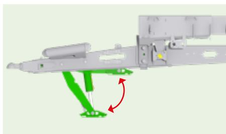
**Гидравлическая стояночная опора** с выдвижными лапами внутри дышла с широкой опорной поверхностью
