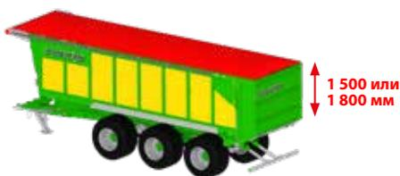
Тент типа Cabriolé (водонепроницаемый), без/с надставными опущенными бортами **B** (невозможно использовать тент с поднятыми надставными бортами).
