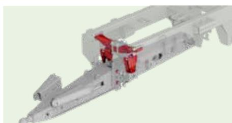
**Дышло с механической подвеской** (на поперечных рессорах) на моделях tandem.
