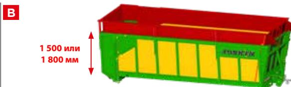
Боковые гидравлические надставные борта 50 до 550 мм выдвигаются индивидуально - передний козырек с ручным складыванием - механическая задняя дверь с 4-мя позициями.
