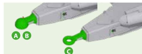
**Выбор между различными моделями встроенных сцепных серег на болтах**
