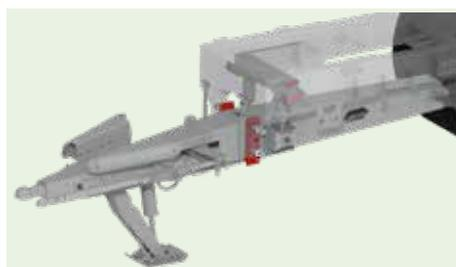
**Стальная направляющая дышла для передней подвески** с точками смазки и регулировкой с помощью 4 прижимных винтов.
