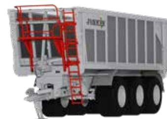
Передний балкон (только для кузова высотой 1 800 мм).
